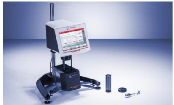
Рисунок 1. Ротаційний віскозиметр ViscoQC 300 з PTD 80
